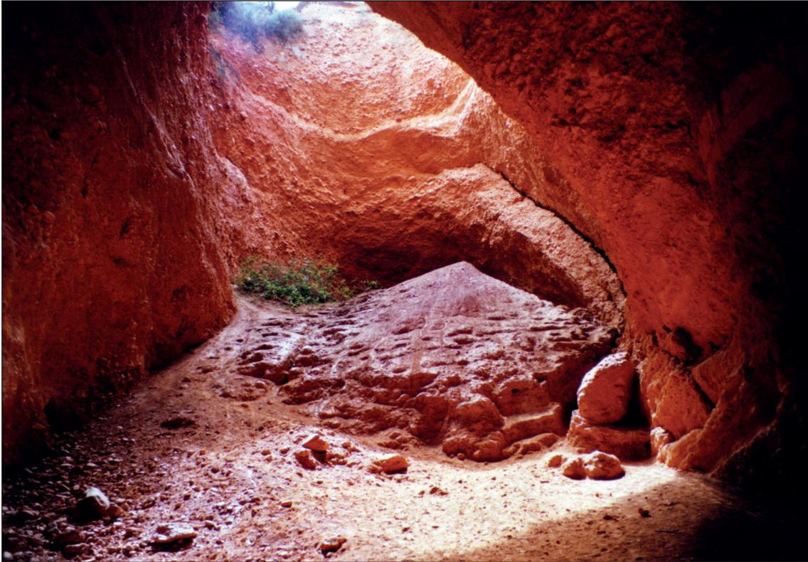
Abb. 7: Grubenbau in Las Médulas: In Bildmitte beim letzten Ausschwemmen gelöstes Material, das in rund 1800 Jahren nach dem Ende des Bergbaus wieder zu Konglomerat erhärtete. (Foto © B. Cech)
